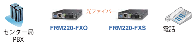
接続例 2: 光ファイバーを介した音声通信 2km ~ 120km
