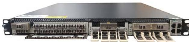
DCI データセンター相互接続アプリケーション向けの 400/200/100G DWDM 伝送プラットフォーム。この製品は、大伝送容量、省サイズ、低消費電力でデータセンターアプリケーション要件を完全に満たしています。近距離相互接続と長距離伝送の両方に適しており 100G/10G クライアントをサポートします。ライン側では 200G・400G の単一波長 CFP2 チューナブル DWDM コヒーレントや複数の FEC をサポートします。100G/10G クライアント信号を 400G/200G ラインへ集約し、長距離伝送を可能にすることでデータセンター・プロバイダー・ダーク事業社へ最大 1.6T の相互接続を提供します。23dB100km 区間に対応でき、アンプ、DWDM フィルタを使用することで更なる拡張が可能です。
