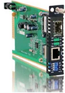
FRM220-10/100IS-D は 10/100Base-TX から 100Base-FX のファストイーサネットメディアコンバータです。FRM220-CH20 集合型シャーシに収容すると光コンバータモジュールとして使用でき、インバンド管理機能を使って遠隔のコンバータの帯域制御、デデュプレックス (二重化)、速度などの各種設定の管理やリンク / 電源の状態監視が行えます。その他に FRM220-10/100IS-D モデルはスタンドアローンシャーシでは DIP スイッチによる設定管理もできます。
