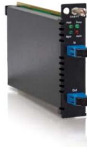
FRM220-OAB15 は、FRM220 のシャーシによって管理可能な C バンド用 1 チャンネルのラインカードモジュール型ブースターアンプ (EDFA 光増幅器) です。優れた広帯域ノイズ性能を提供しながら、広いダイナミックレンジを備えています。ラック管理または RS-232 コンソール I/F を介して自動定出力制御 (APC:Automatic Power Control) および自動定電流 (ACC:Automatic Current Controls) を提供します。光入力値が急速に変化したときに出力値を一定レベルに保つことができます。
