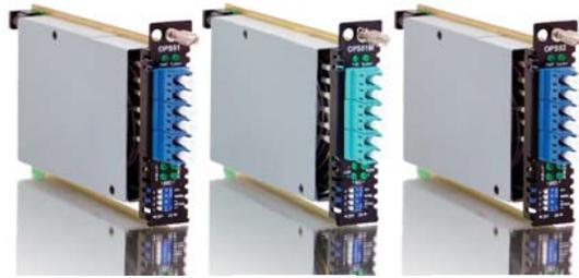
FRM220-OPS シリーズは、チャンネルごとの光ファイバの冗長を可能にします。これらのユニットは、CWDM および DWDM リンクを含む全てのタイプの光ファイバデータ伝送を保護/保障するのに適しています。このソリューションには、現用ファイバおよび保護パス光ファイバのモニタリング機能が含まれています。アクティブパスで光ファイバを切断した場合、トラフィックは 50ms (FRM220-OPS51) または 20ms (FRM220-OPS52) 未満で保護されたパスに切り替えられます。両方のカードが SNMP 管理付きの FRM220 ラックに置かれている場合、SNMP 管理によって監視が可能です。管理者は、コンバータカードの状態/種類/バージョン/ファイバリンクステータスやアラームを表示できます。ポートの有効/無効、リセットやスイッチするタイミングの閾値などカードモジュールで設定する事ができます。850nm 対応マルチモードタイプ (FRM220-OPS51M) も新たにシリーズに加わりました。
