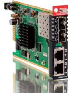
FRM220A-2000EAS/2 は 2 × 10/100/1000Base-T 及び 2 × 100/1000Base-X SFP を保有したスイッチです。ネットワーク管理者は、SNMP やウェブ管理機能をサポートしたスタンドアロンシャーシや集合型シャーシを用いてローカル及びリモートに接続された OAM 準拠のコンバータを監視 / 設定 / 制御することができます。このギガビットコンバータは、帯域幅制御、速度設定、VLAN タグ、Q-in-Q、QoS、スパニングツリー、自動レーザーシャットダウン、リンクフォールトパススルー、OAM ループバック、DyingGasp などのレイヤー 2 スイッチの技術もサポートします。これらのカードは FRM220A の集合型シャーシに搭載した GSW/SNMP 経由で監視や制御することも可能です。
