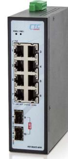
IGS-802CS-8PH は産業用 100M/1G PoE イーサネットスイッチです。アンマネージド & プラグアンドプレイ設計で使いやすく、8 つの 10/100/1000Mbps UTP ポートを備え、各ポートは 30W PoE+ に対応しています。光ファイバー接続用の 100/1000Mbps SFP スロットを 2 つ搭載しており、拡張伝送距離、ファンレス設計、高 MTBF を満たし幅広い動作温度と冗長 48VDC 電源に対応しているため、使用環境が商用製品の仕様を超える産業用工場、オートメーションやデータセンター、インテリジェントな輸送システム、軍事および公共事業市場アプリケーションなどの厳しい環境での高負荷アプリケーションにも適しています。
