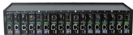
寸法 : 476(W) × 199(D) × 88 (H)mm 重量 : 7.9Kg
