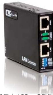
LAN エクステンダー LX100 をペアで使用することでイーサネット規格である最大 100m の制限を超えて延長できます。1 または 2 ペアの UTP ケーブルを用いてポイントツウポイントの対向接続で最大 800m まで通信可能。
