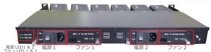
電源 LED1 &amp; 2, ファン LED 1 &amp; 2, 電源 1, ファン 1, 電源 2, ファン 2
