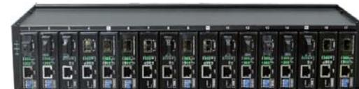
寸法 : 476(W) × 199(D) × 88 (H)mm 重量 : 7.9Kg
