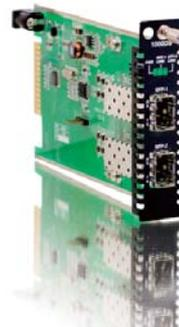
FRM220-1000DS は、1Gbps までのデータ変換を可能にする光ファイバ 対光ファイバのメディアコンバータ/リピータです。FRM220-1000DS は、2R 再生 (再増幅と再形成から構成) をサポートします。このコンバータは、100Mbps ファストイーサネットや 100Mbps ギガビットイーサネット、STM-1、ファイバチャネル 1、OC3 などのファイバインターフェイスと互換性もあります。FRM220-1000DS は FRM220-CH01 と組み合わせることで、スタンドアロン光コンバータとして使用できます。FRM220-1000DS カードを SNMP 管理付きの FRM220-CH20 ラックに設置すると管理者はこのカードのステータス、タイプ、リンクステータス、および SFP の DDM 情報など確認できます。
