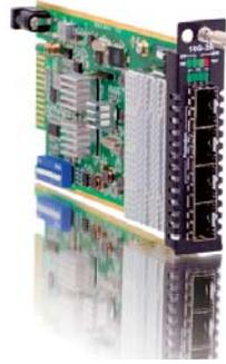
FRM220-10G-3R は 4 つの SFP + を保有し、デュアルチャンネル 10G 3R マルチレートトランスポンダー又は 1 対 2 のライン切替機能として使用できます。このデバイスは、1G/10G イーサネット、SDH STM16 / STM64、OTU1 / OTU1e / OTU2 / OTU2e、光ファイバーチャンネル 1/2/4/8/10/16、ODU、OBSAI、CPRI など様々なプロトコルに対応し、柔軟な伝送を提供します。CWDM または DWDM 波長の SFP+ を使用すると、10G トランスポンダーは 1Gbps から最大 10Gbps の光通信速度でマルチレート機能をサポートします。これにより FRM220-10G-3R トランスポンダーは、長距離伝送用のリピータとしても適しています。近年の部品の性能の向上により、以前のトランスポンダーに比べて電力条件および放熱などが大幅に改良されました。
