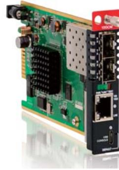
FRM220-10GCM は、2 ポートの 10GBase-R と 1 ポートの 100M/1G/2.5G/10GBase-T イーサネットコンバータです。SNMP と Web ベースの管理機能を内蔵しており、ネットワーク管理者は各 10G コンバータ（ローカルおよびリモート）を監視、設定、制御することができます。
