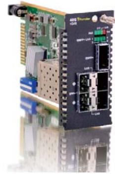
FRM220-40G-1Q4S は、40G QSFP+ ~ 4 x 10G SFP+ トランスポンダーで、10G 対 40G のメディア変換を行い、伝送距離の延長を可能にします。FRM220-40G-1Q4S は帯域を必要とするデータセンターや企業の要求に合わせて開発されました。40G イーサネットインターフェイスを備えたハイエンドサーバとイーサネットスイッチの登場により、メディア変換（マルチモードからシングルモード）とリンク範囲の拡張が必要になります。FRM220-40G-1Q4S は 2 スロット分のワイドタイプのカードモジュール<sup>(※1)</sup> で 40G QSFP+ x 1 ポート及び 10G SFP+ x 4 ポートを保有したトランスポンダーです。インストール方法はとても簡単でプラグアンドプレイ方式でご使用頂けます。FRM220-40G-1Q4S は FRM220-CH20 集合型シャーシと合わせて QSFP+ や SFP+ を必要とするアプリケーションに最適です。
