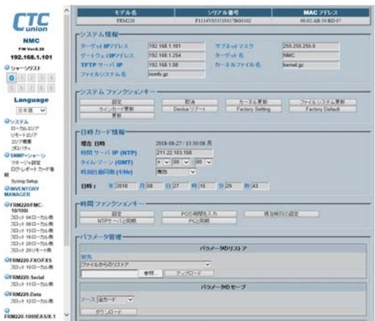
管理画面(図4)では、シャーシに搭載している各ラインカードモジュールの詳細なステータスを表示し、カードの設定を変更することができます。Web GUIを使用することで、簡単なマウスポイントとクリックで設定を行うことができます。
