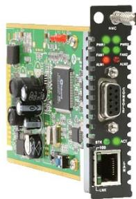
FRM220-NMC は FRM220 シリーズシャーシに収容することでシャーシに搭載したインターフェイスカードモジュールの管理ができるネットワーク管理コントローラカードです。管理インターフェイスは、Telnet、HTTP、および SNMP プロトコルによるローカル RS-232 シリアルコンソールまたはリモート TCP / IP 管理をサポートします。カードはホットスワップ可能で、他のカードモジュールのライン / 通信に影響を与えることなく交換が可能です。またこの NMC を使って、シャーシ内のスロット毎にファームウェアアップグレードが可能です。その際、他に挿入されているカードモジュールの伝送に影響を及ぼすことはありません。標準の NMS のサポートは、付属のエンタープライズ MIB ファイルによって提供されます。また多数のネットワークを監視 / 維持する Java ベースのクライアント / サーバマネージャである、独自の EMS (要素管理システム) を提供します。
