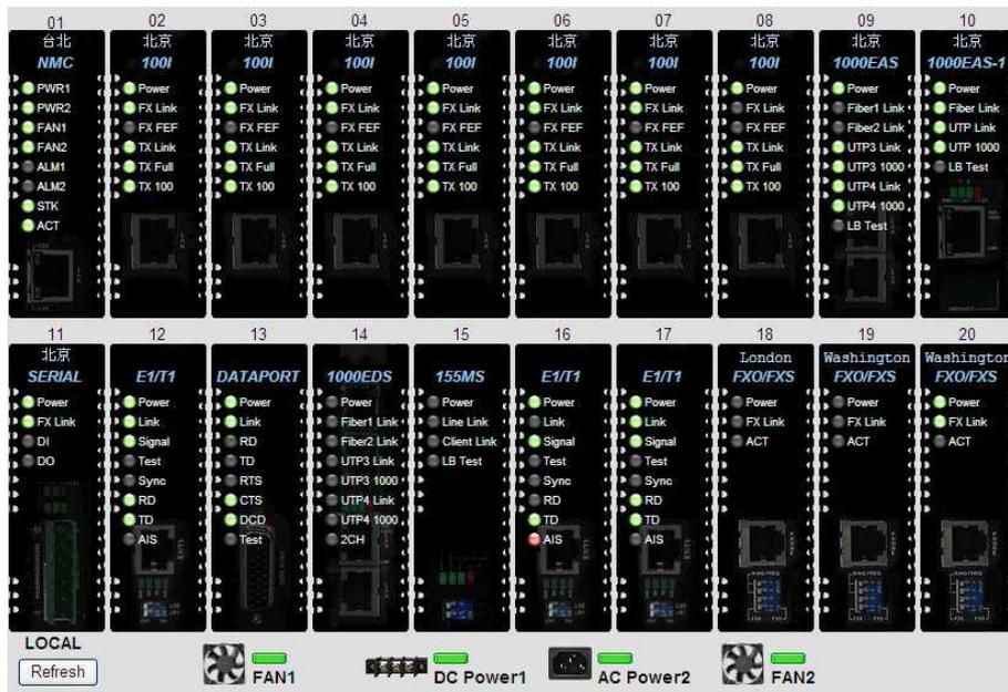
画面の下方にあるボタンは2つの電源モジュールと2つのファンのリアルタイムのステータスを表示します。これらにエラーが発生した場合はLEDが赤く点滅します。
