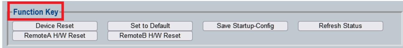
**Device Reset/デバイスリセット**：カードのウォームブートを強制し、Startup-Config の設定を起動時に読み取ります。
